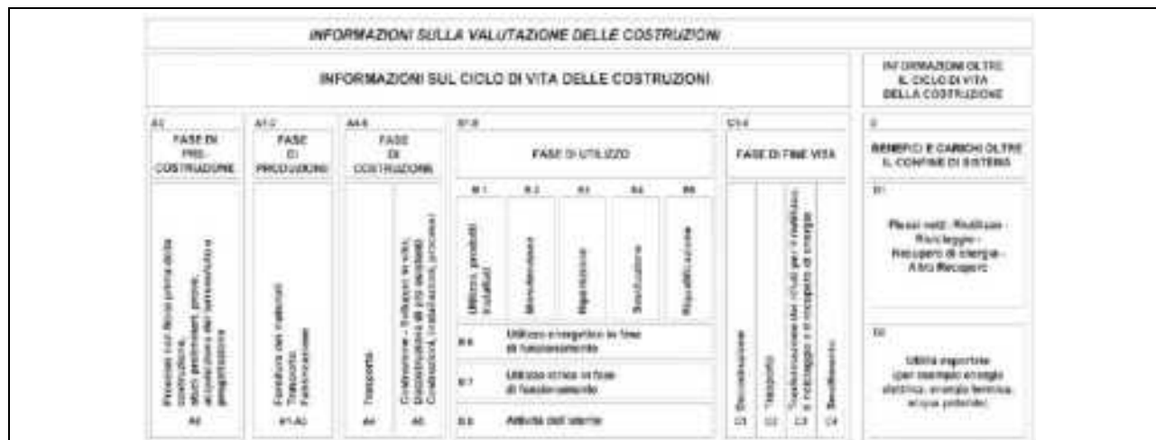
Figura 1 - Fasi del ciclo di vita di un'opera civile secondo norma UNI EN 15643
